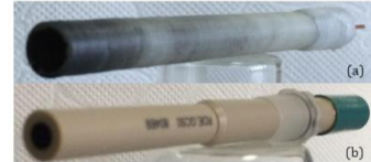
Şekil 3. (a) Tasarlanan elektrot "KPE" (b) ticari elektrot "CKE"
