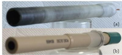
Şekil 3. (a) Tasarlanan elektrot “KPE” (b) ticari elektrot “CKE”
