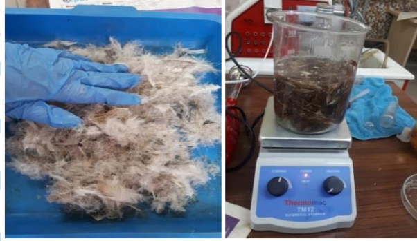
Şekil 4.2.1 Tüylerin öğütülmesi ve karışımın manyetik karıştırıcı ile karıştırılması
