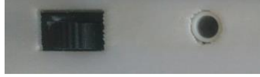
Şekil 5: Ses çıkışı seçim anahtarı ve kulaklık girişi
