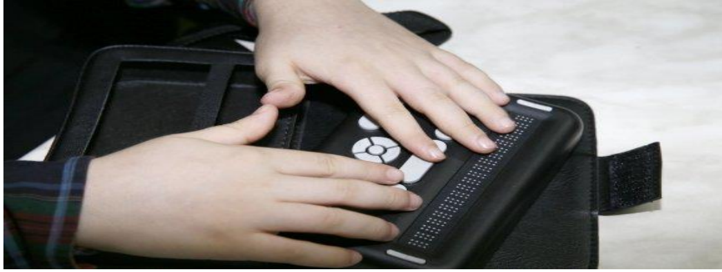
Şekil 7: MEB tarafından dağıtılan Braille Okuma Yazma Cihazı
