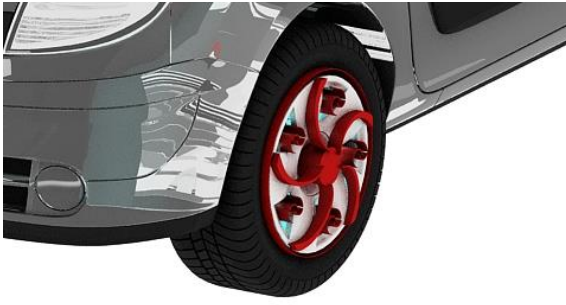
Şekil 5. Dikey Eksenli Savonius Rüzgar Tribünü Araç Tekerleği Perspektif Görünüşü
