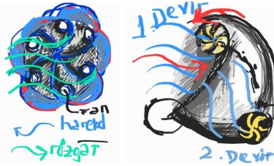
Çizim 1. Dikey eksenli Savonius Rüzgar Tribünü Ön Görünüş ve Detay Eskizi
