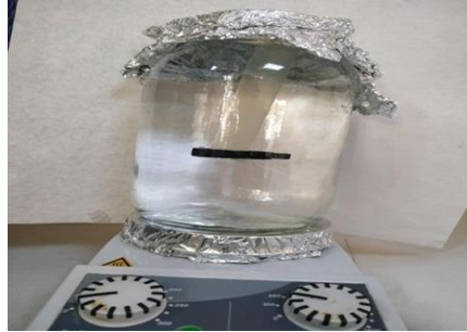
Şekil 8. İpek fibroini çözeltisinden diyaliz işlemi ile \text{CaCl}_2 'nin uzaklaştırılması
