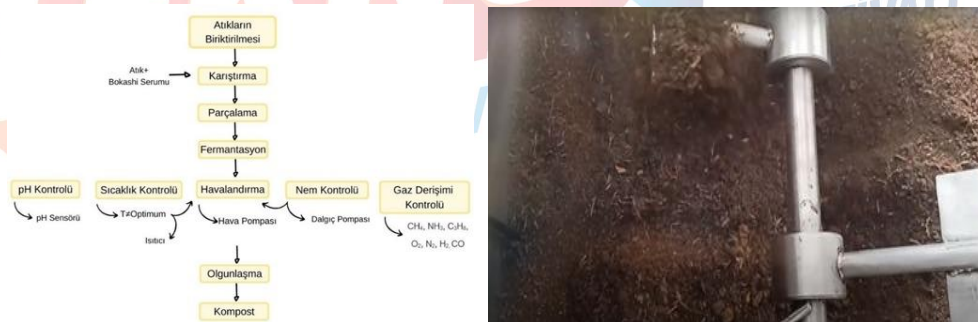
Şekil 4: Sürecin yönetimi için kullanılan akış kontrolü ve kompostlaşma süreci tamamlanmak üzere olan evsel organik atık.
