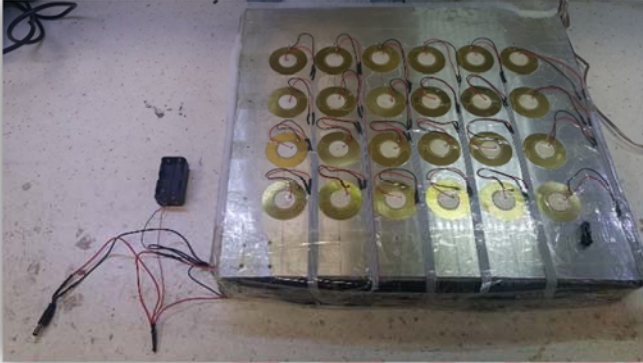
3.a Enerji hasadı ünitesinin piezo elektrik malzemelerden oluşan ilk yüzü
