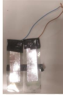
Şekil 14: Alüminyum elektrotlu PDMS filmlerin görüntüsü (Ünsal, 2018).
