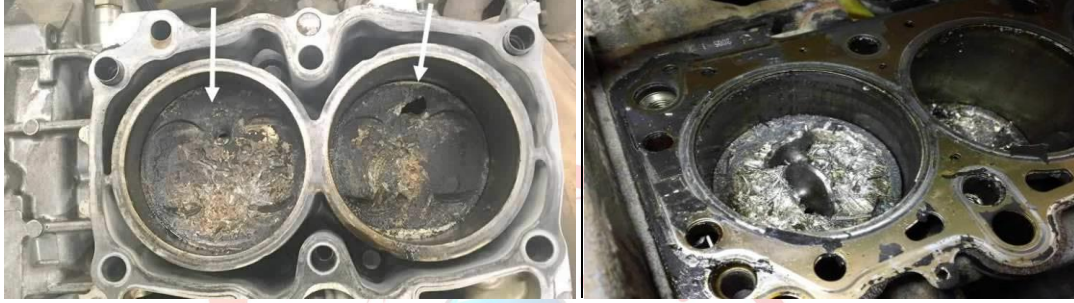
Şekil 2.1. Trigeri kopmuş motordaki hasarlar
