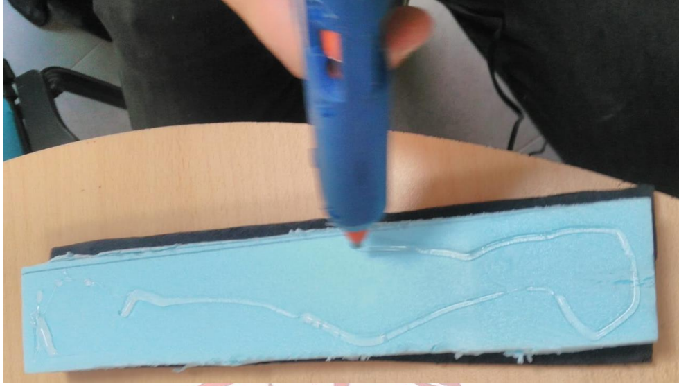
Şekil 5: Mikrofiber malzemenin kenarlarının kaplanması ve süpürge etkisi için alt tarafında pay bırakılması.
