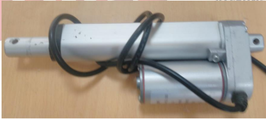
Şekil 2: Kullanacağımız DC 12 V 50-300mm 200N İnme Borulu Motor Doğrusal Aktüatör Motor.
