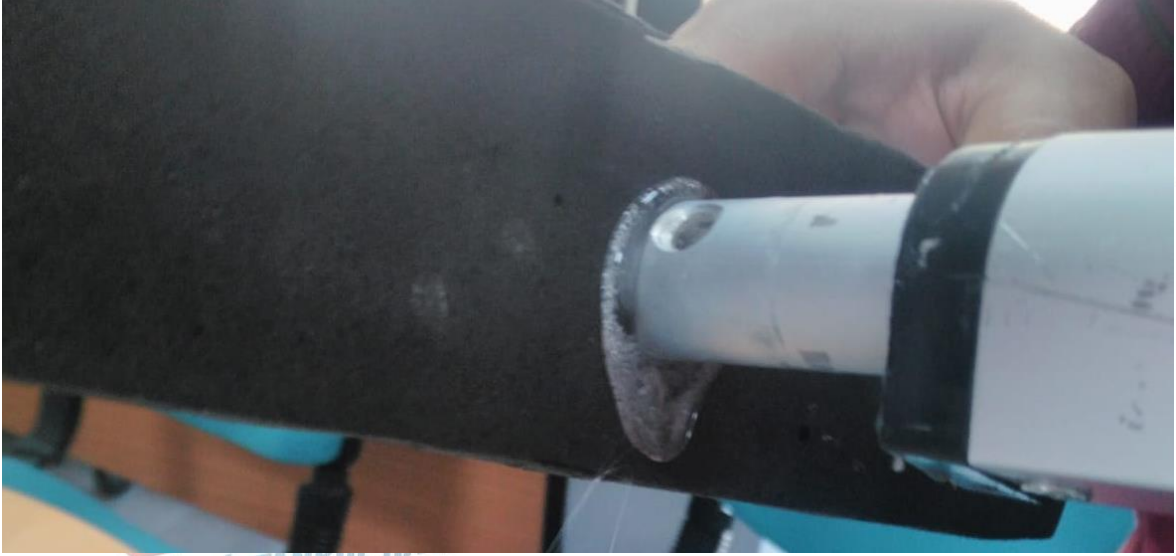
Şekil 6: Mikrofiber malzemenin motora yapıştırılması.
