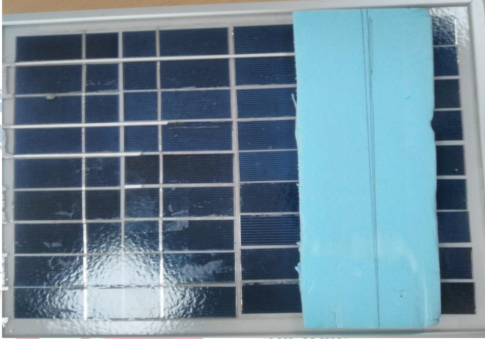
Şekil 4: Panel için uygun boyutta kesilen mikrofiber malzeme.
