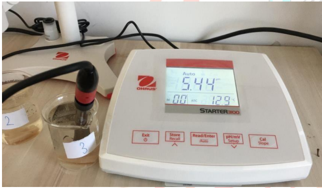
Şekil 6: Üçüncü grup numunesinin pH ölçümü
