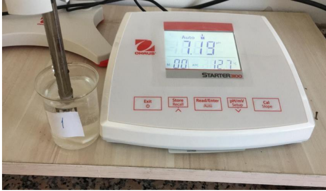
Şekil 5: Birinci grup numunesinin pH ölçümü
