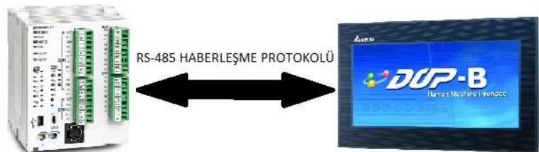
Şekil 11. PLC ve SCADA haberleşme şeması
