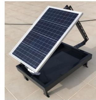
Şekil 1: Alg havuzu entegre edilmiş güneş panel sisteminin aşamaları
