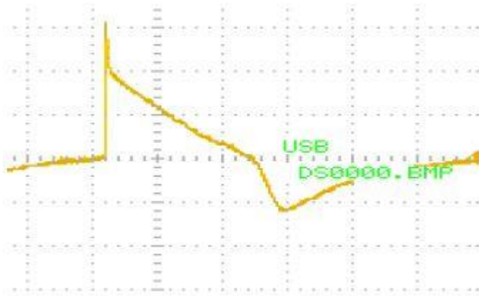
Resim 4. Piezo seramiklere basınç uygulandıęında oluřan gerilim dalga řekli
