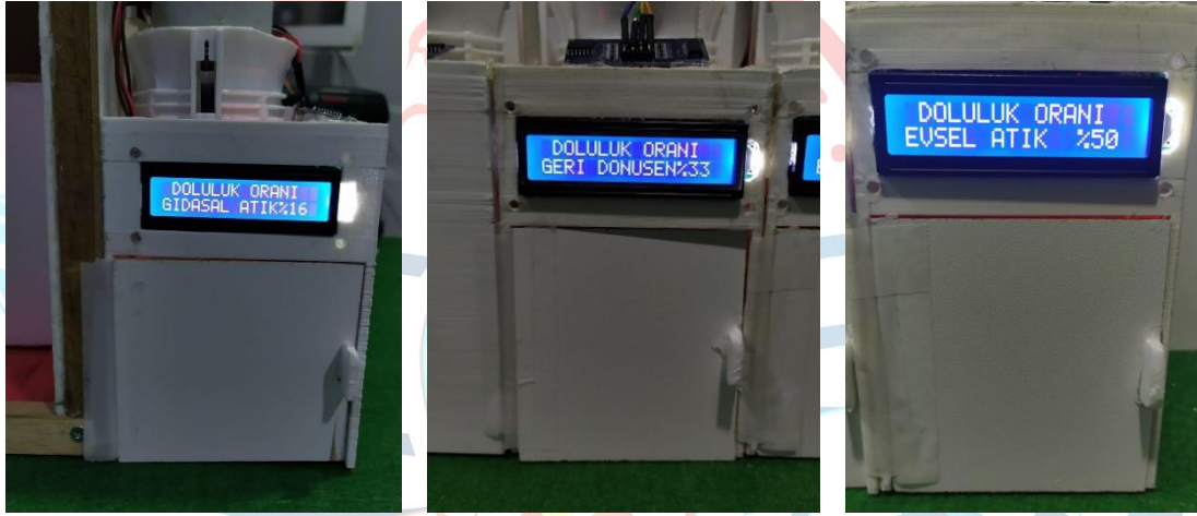
Resim 5: Sistemin çalışmasının LCD ekranlar üzerinde test edilmesi
