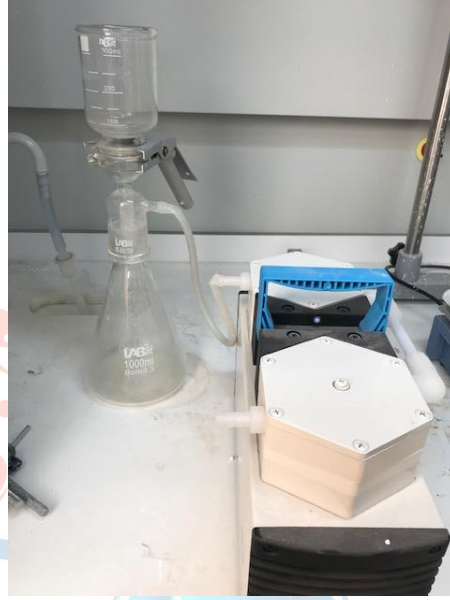
Şekil 4. Manyetit ve Arsenik İçerikli Suyun Ayırıştırıldığı Vakumlu Süzme Cihazı
