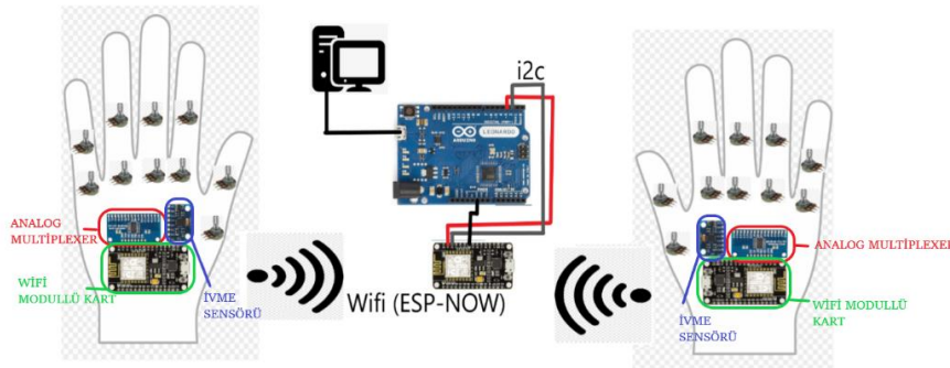
Şekil 1 Çevre kontrolör, denetleyici ve yazılım etkileşiminin tasarımı
