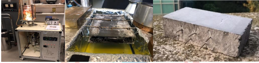
Şekil 4.1: Standart Boyutta (5x10x20 cm) Üretilen Isıl Pil Prototipinin Yapılış Aşamaları
