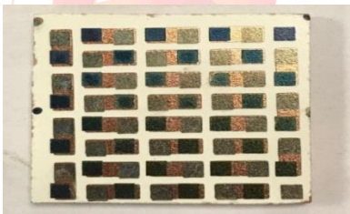
Şekil 5.1 Kaplama Yöntemi ile N-tipi P-tipi
